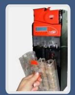
La apertura del cajón mediante la llave o la contraseña se registra en un historiador específico que no se puede modificar; por lo tanto es posible controlar durante la fase de detección de los datos cuando el grupo de los tubos se ha abierto, con que llave o código (hasta 5) y durante cuanto tiempo.
